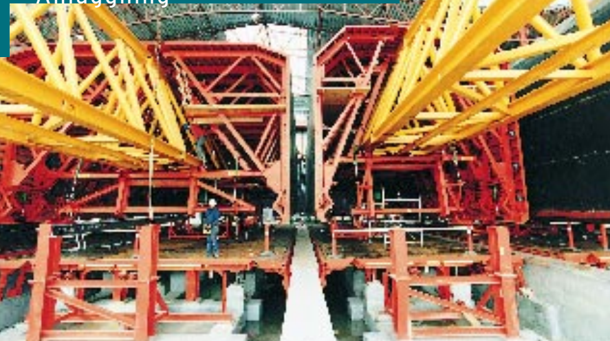
Tunnelsegmenten tillverkas under kontrollerade klimatförhållanden i den specialuppförda fabriken i Norra Hamnen i Köpenhamn.
