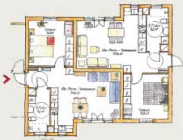
Den här planritningen visar ytsnåla tvårumslägenheter på 48 kvm försedda med ljusa och luftiga kök samt rymliga badrum med plats för badkar och tvättmaskin. (Illustration: Origo Arkitekter AB.)
